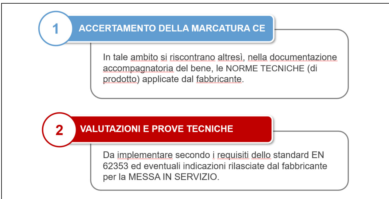
Figura 3: principali fasi relative alle operazioni di COLLAUDO di un'apparecchiatura o un sistema elettromedicale.
